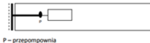
Rysunek 2. Kanalizacja ciśnieniowa
